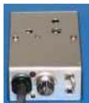
Les 3 potentiomètres ajustables sont situés sur le dessus du coffret.
